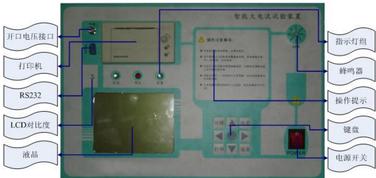
图 2 面板结构图
